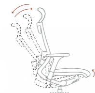
- Schienale in rete - Sedile imbottito in schiumato a freddo - Meccanismo syncro
