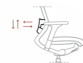
- SUPPORTO LOMBARE REGOLABILE IN ALTEZZA E PROFONDITÀ
